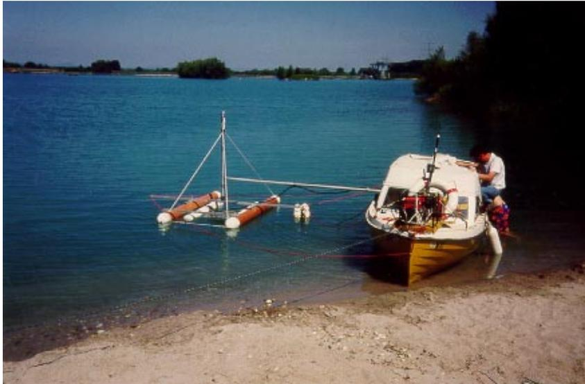
Abbildung 4.14: Meßvorrichtungen: Links am Ausleger der *sonic boomer*, in der Mitte das Hydrophon. Energieversorgung und Rechner befinden sich im Boot.
